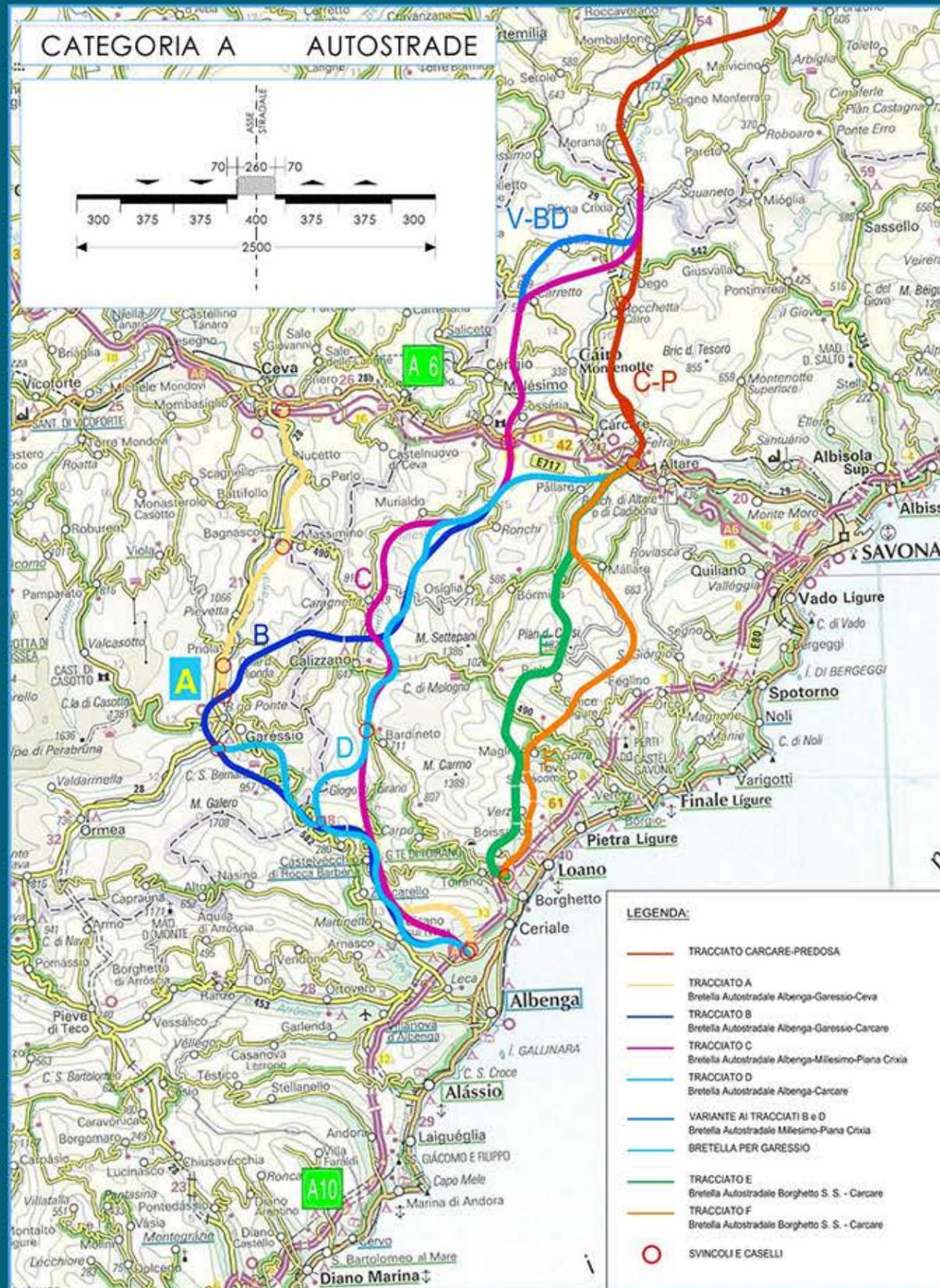
Per ogni tracciato si era analizzato l'andamento plano-altimetrico adeguandolo, quando è risultato necessario, al quadro normativo di riferimento, ed in particolare al D.M. 05/11/2001 "Norme funzionali e geometriche per la costruzione delle strade".
